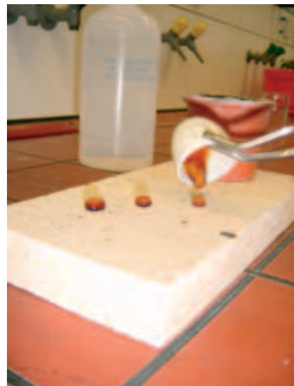
Abbildung 1: Glasschmelze: Die flüssige Glasschmelze wird in Portionen gegossen...
